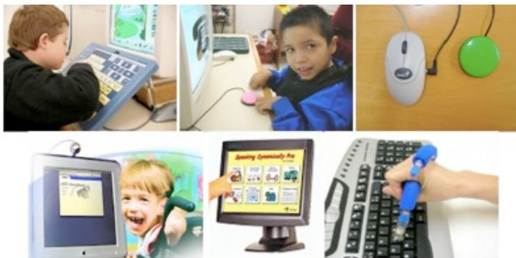
**Figura 4:** TA para Teclado IntelliKeys, acionadores com *mouse* adaptado, *mouse* por movimento da cabeça, monitor com tela de toque e órtese para digitação. Fonte: Bersch (2008).
