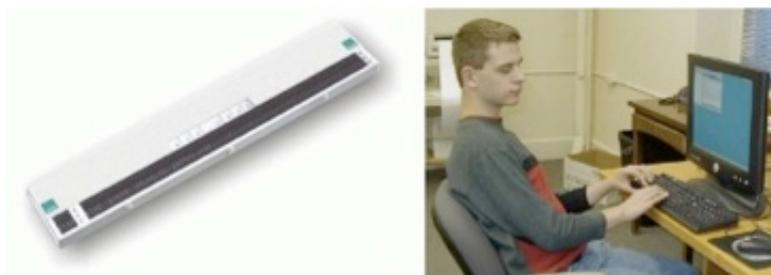
**Figura 5:** TA para dispositivo de saída linha braille e *software* para controle do computador com síntese de voz. Fonte: Bersch (2008).
