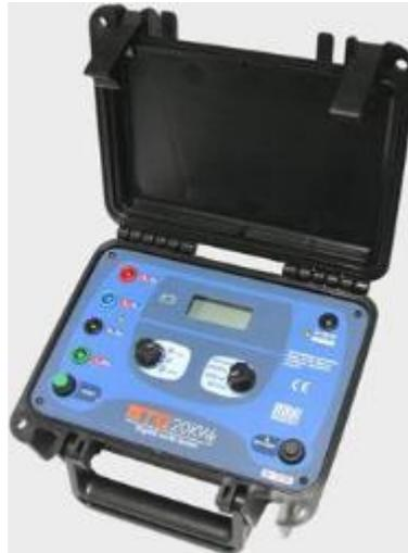
Figura 5- Terramômetro digital [<http://www.ebah.com.br/content/ABAAAemy0AE/aterramento-eletrico>]
