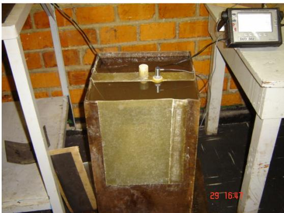
**Fig. 4.2 (a)** – Detalhes do tanque com HCl.
