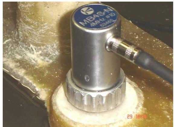
**Fig 4.2 (b)** transdutor acoplado à Alumina.
