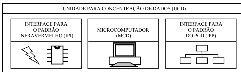
Figura 3. Arquitetura da Unidade para Concentração de Dados (UCD).
