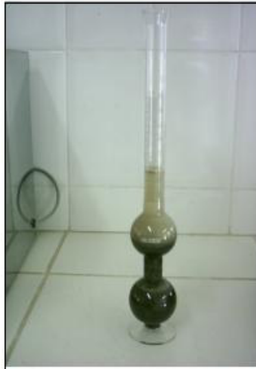
Figura 6. Frasco de Chapman utilizado para o ensaio do pó de dunito.
