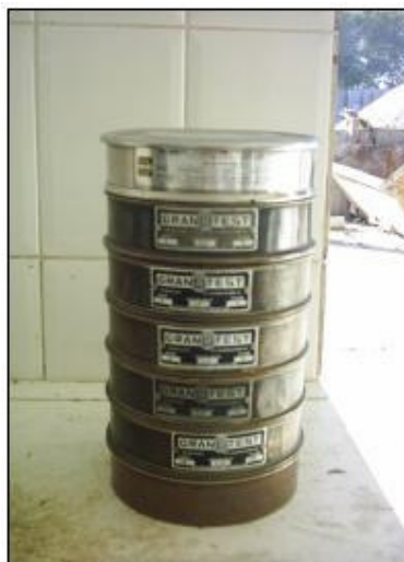
Figura 8 Conjunto de peneiras utilizadas nos ensaios granulométricos.
