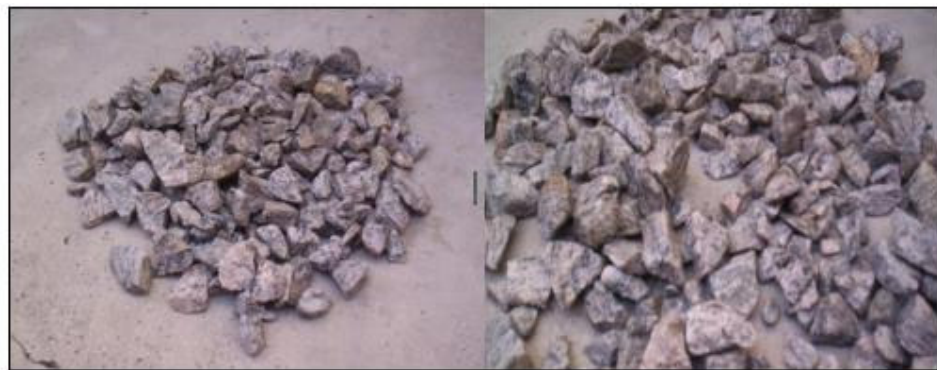
Figura 2. Rocha Gnaisse - Pedreira Um Valemix.
