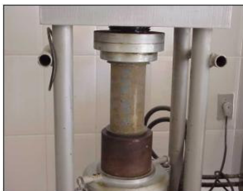
Figura 13. Disposição do CP na prensa utilizada no ensaio de resistência à compressão.
