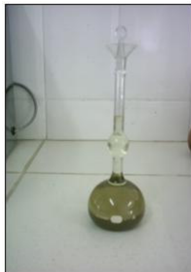
Figura 7. Frasco de Le Chatelier utilizado para o ensaio do cimento e escória.
