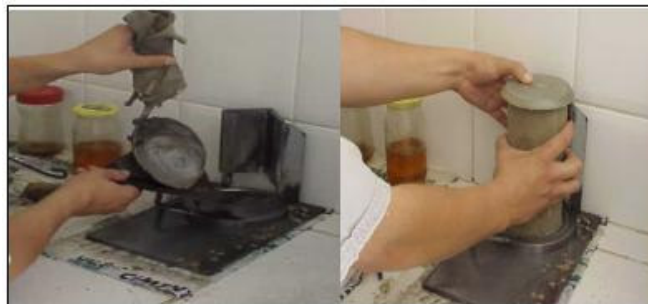
Figura 12. Capeador para corpos de prova cilíndricos.
