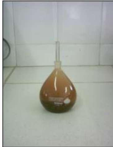
Figura 4. Picnômetro utilizado para ensaio da areia.
