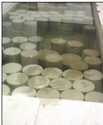
Figura 11 Tanque de cura dos CP's.
