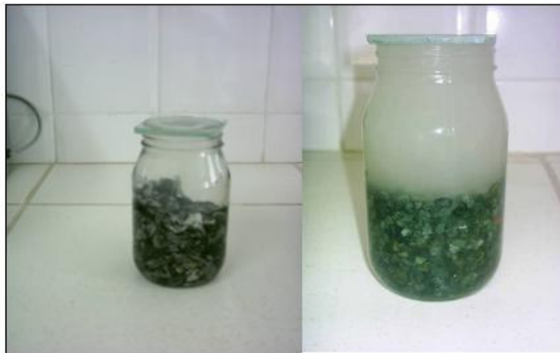
Figura 5. Picnômetro utilizado para ensaio das britas.
