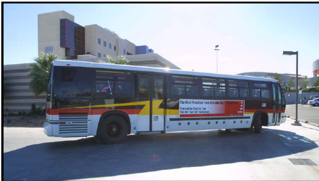
Ônibus elétrico com célula Zinco/Ar, em operação experimental no Arizona, EEUU, 2004. Ver Relatório dos testes - fase III www.electric-fuel.com/evpro/Phase3.pdf
