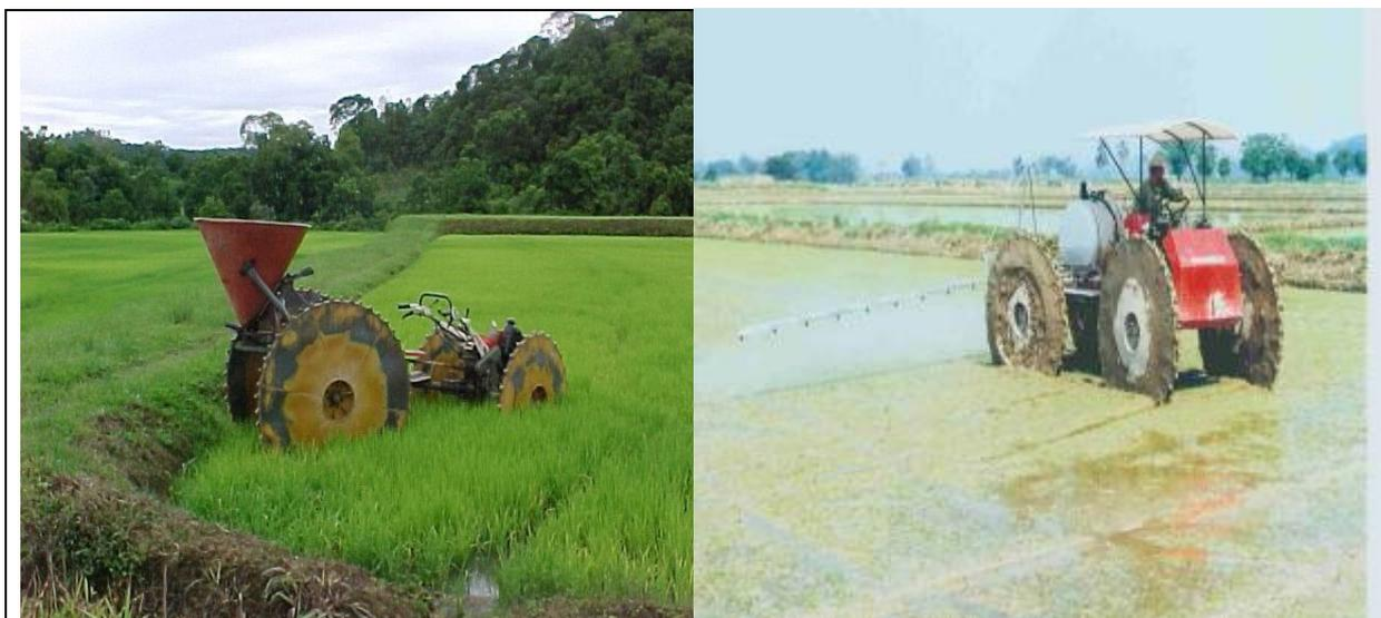
**Figura 3** Tobata adaptado para sementeação e adubação e Máquina de herbicida e inseticida – pulverização.
