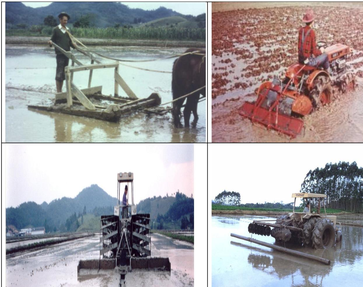
**FIGURA 02:** Preparo de solo com trator e rodas de ferro e também alisamento.
