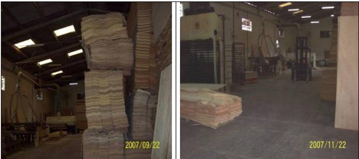
**FIGURA 4** – Situação do corredor de passagem da empilhadeira: Antes e depois do 5s
