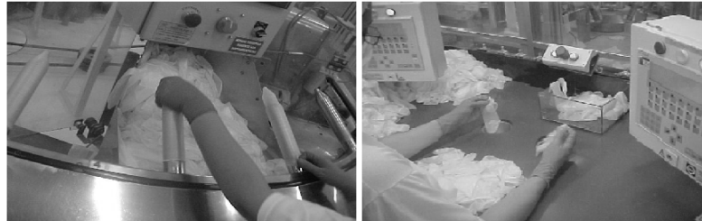
Figura 4 Colocação Manual do Preservativo no Molde e Alimentação Manual do Preservativo na Máquina Através de um Duto de Vácuo
