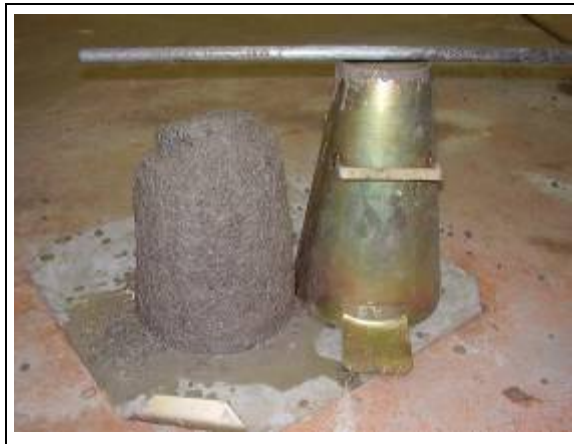
Figura 5. Teste de Abatimento de cone (Slump Test).
