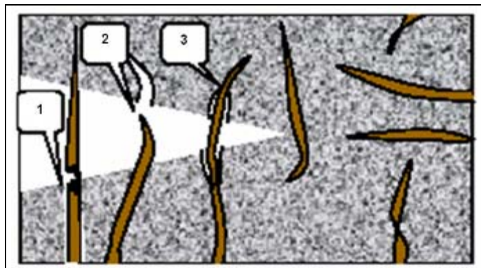
Figura 3. Representação esquemática de uma fissura através de um material compósito reforçado com fibras. Fonte: (SILVA, 2003)
