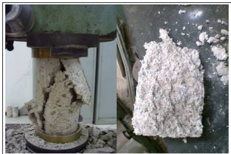
Figura 8. CP's submetidos ao ensaio de resistência à compressão.
