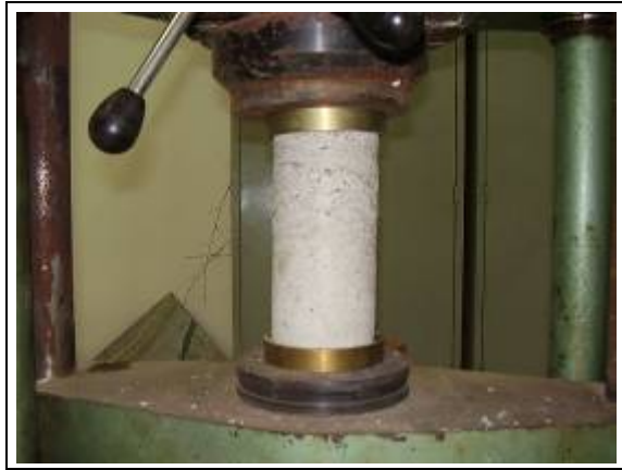
Figura 7. Ensaio de compressão, CP padrão
