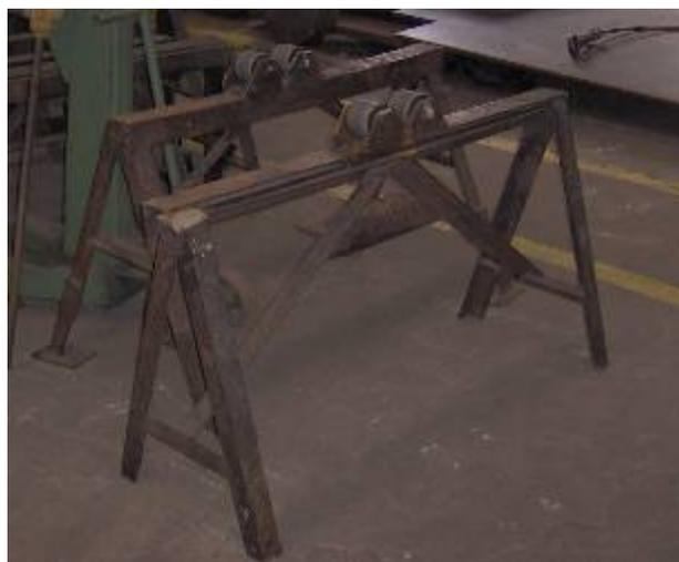
**FIGURA 3** - Cavalete para soldagem
