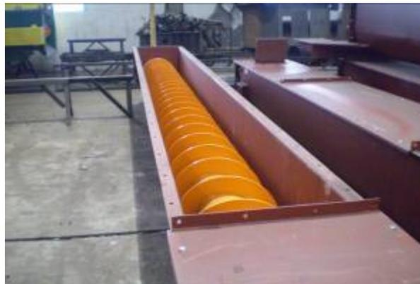
**FIGURA 2** - Rosca Transportadora em calha
