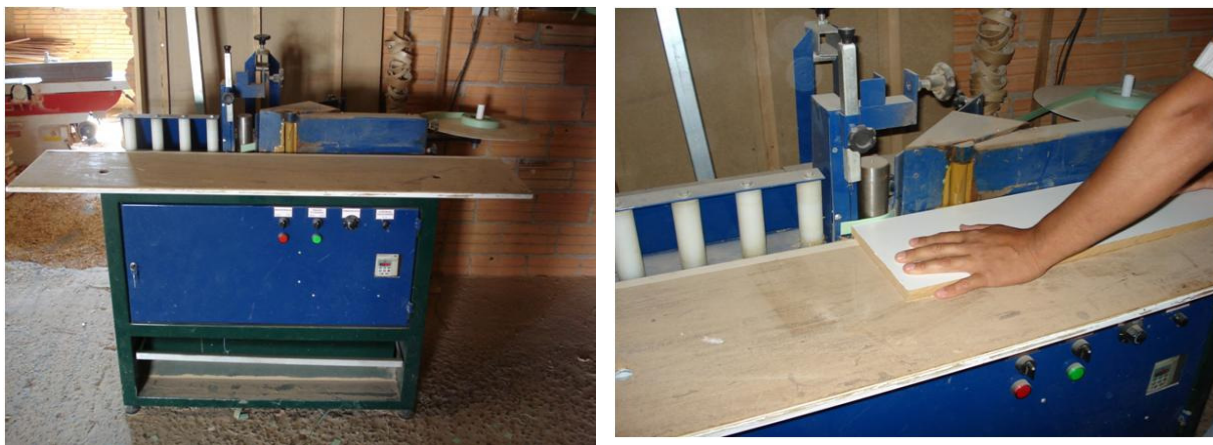
Figura 3 – Foto da Máquina Coladeira de Bordas e do Processo de Colagem de Bordas Mecanizado – colaborador passando peças na coladeira de bordas.
