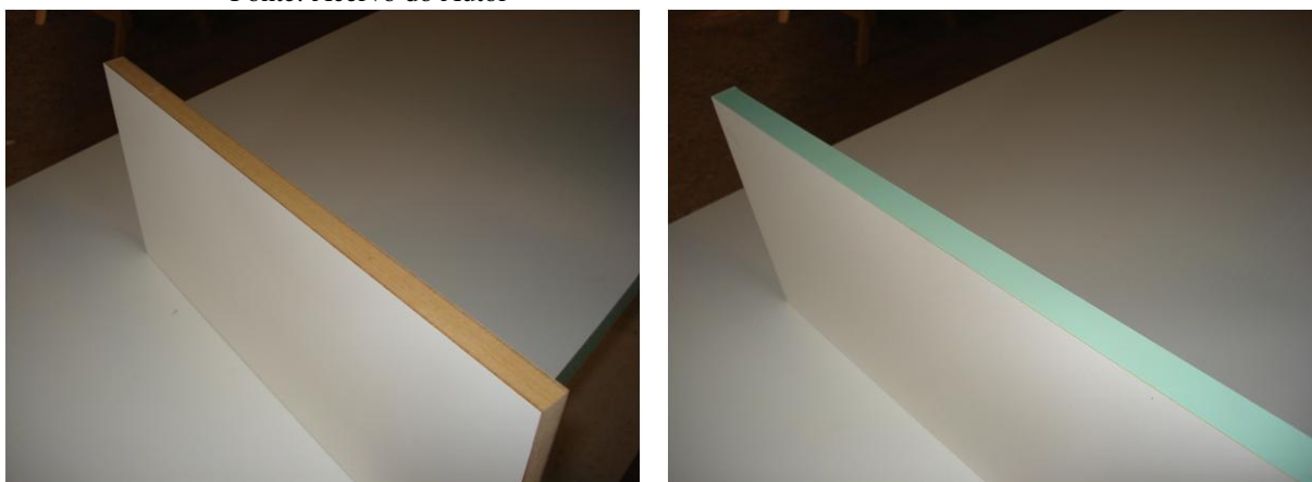
Figura 4 – Comparação de peça MDF antes e depois processo de colagem de bordas.
