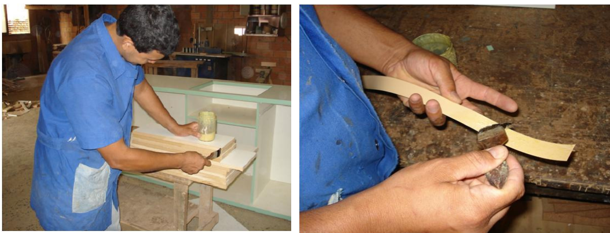
Figura 1 – Processo de Colagem de Bordas Manual – funcionário passando cola nas chapas de MDF.
