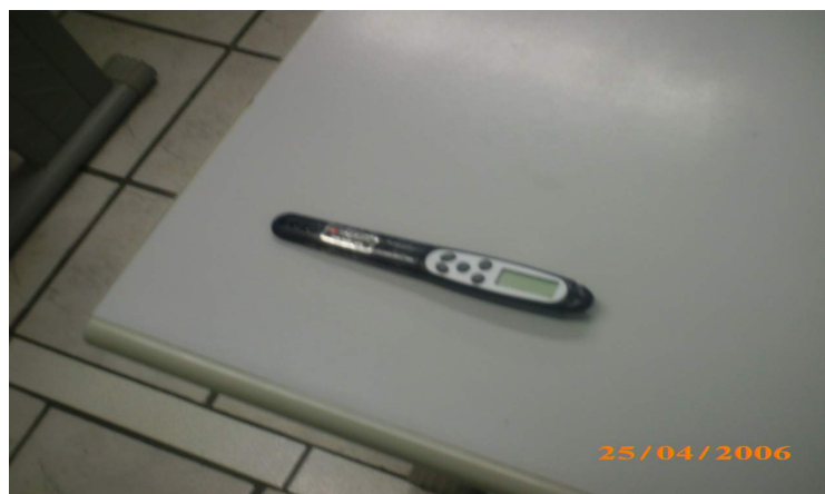
FIGURA 1 – Foto de um termômetro tipo espeto utilizado para as aferições. Fonte: acervo do autor.
