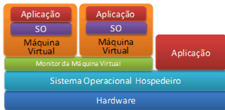
Figura 9: Arquitetura onde o hypervisor é parte do sistema operacional Fonte: http://www.efagundes.com/artigos/virtualizacao_como_fator_estrategico.htm
