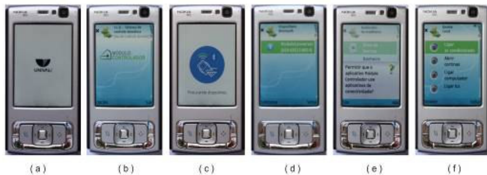
Figura 5. Interfaces do módulo controlador: (a) Splashscreen, (b)Inicial, (c)Aguardando busca, (d) Busca Completa, (e) Seleção de cômodos, (f) Seleção de dispositivos.
