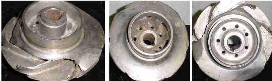
Figura 8 – Corrosão-erosão de rotor de aço inoxidável.
