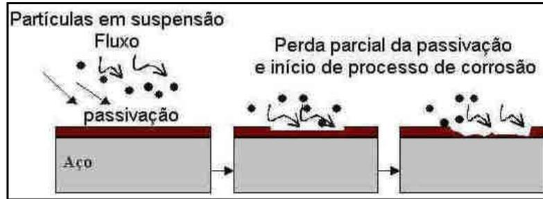
Figura 7 – Mecanismo de corrosão-erosão de aço inoxidável.
