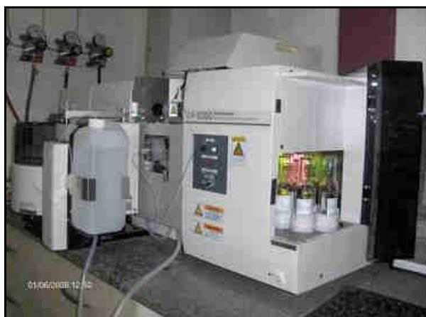
Figura 10 – Equipamento de espectrofotometria de absorção atômica com atomização eletrotérmica
