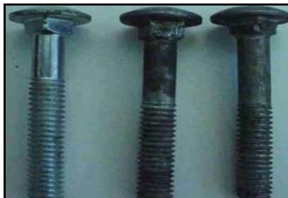
Figura 9 – Parafuso cadmiado corroído
