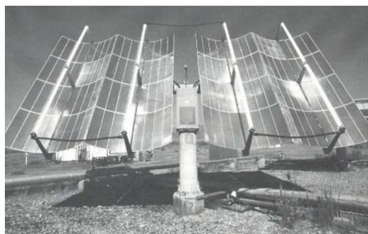
**Figura 4:** Reator solar cilíndrico parabólico.
