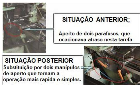
**Figura 5:** Detalhe de dispositivo-porta-faca, antes e depois da melhoria.
