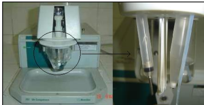
Figura 3 – Aparelho 797 VA Computrace com o destaque da célula de determinação do cádmio
