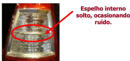
**Figura 3:** Espelho Interno não conforme
