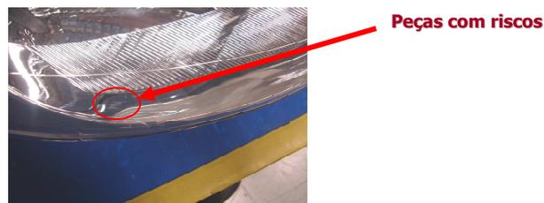
**Figura 4:** Farol com risco externo
