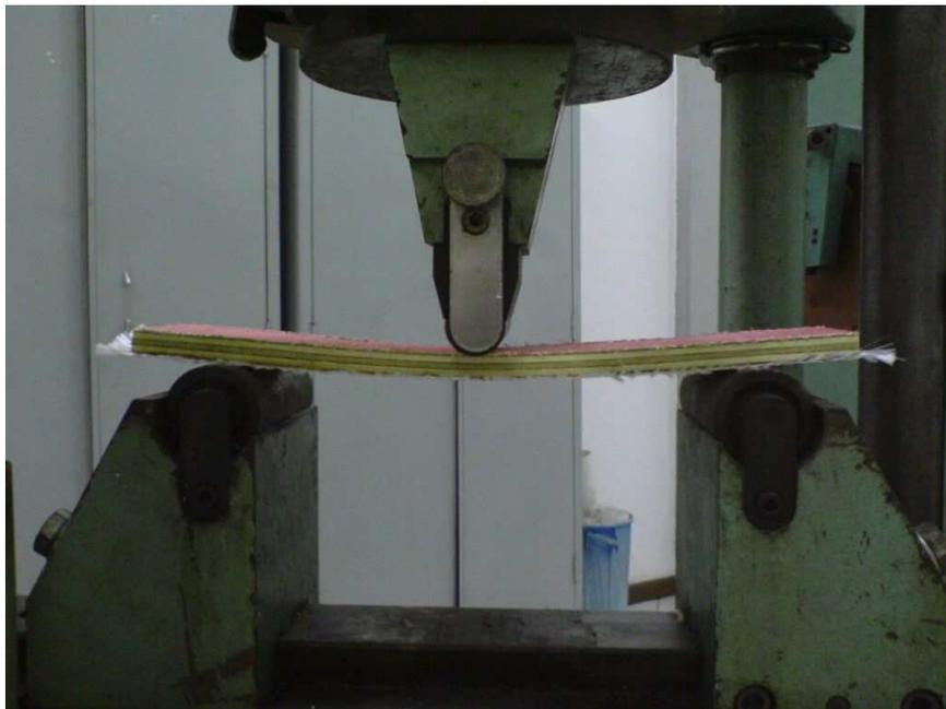
Figura 4- Ensaio de flexão estática.
