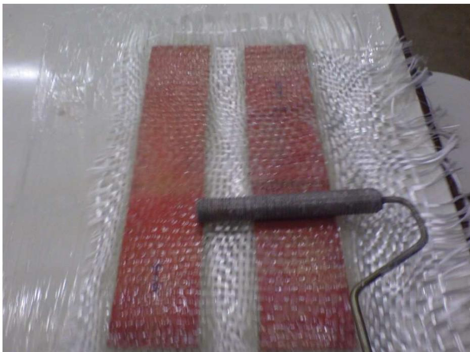
Figura 3 - Desaeração dos corpos de prova.
