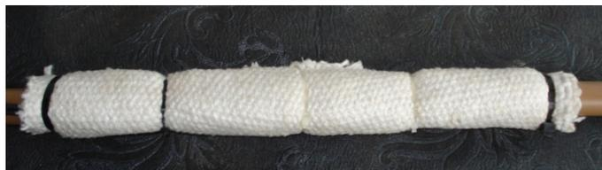
Figura 7 – Isolamento térmico do medidor
