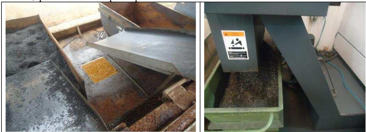
Figura – Rampas de despejo do cavaco e Carrinhos para armazenar durante a usinagem.
