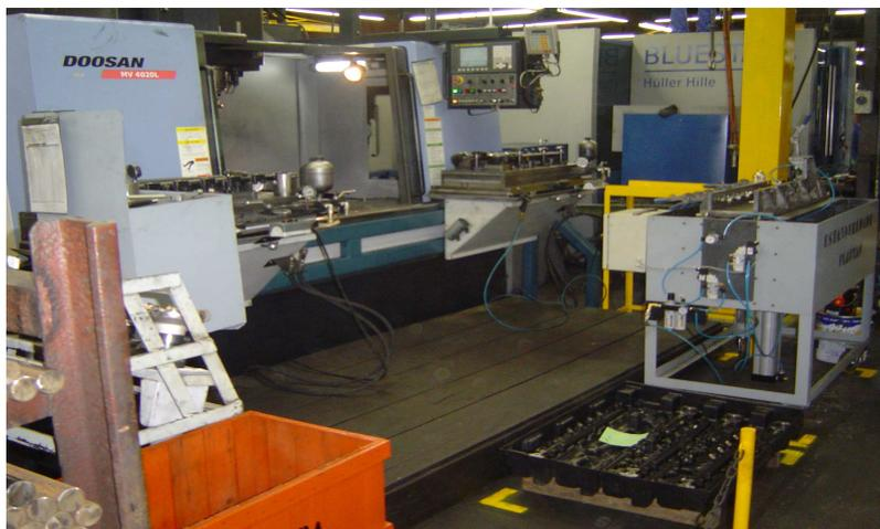
Figura – Centro de Usinagem Vertical
