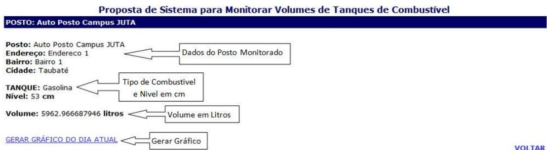
**Figura 7:** Janela principal da Interface Homem-Máquina Remota.
