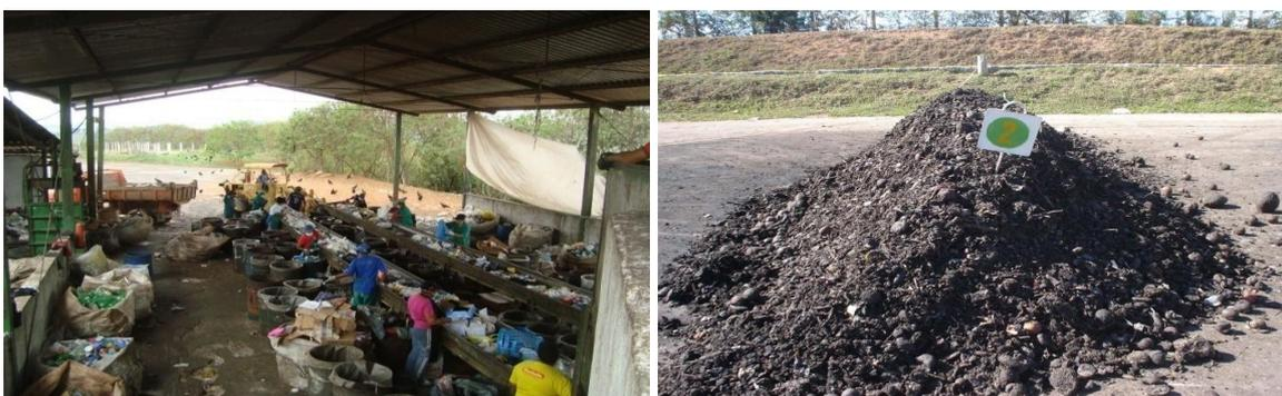
Figura 05: Separação dos resíduos sólidos na esteira e composto orgânico no pátio de compostagem.
