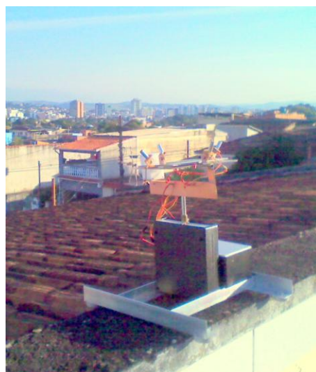
Figura 8: Protótipo da plataforma mecânica do rastreador solar
