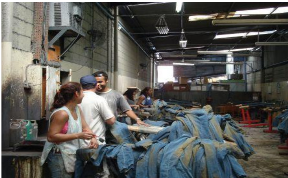
Figura 5. Funcionários no setor Pincel sem equipamentos de proteção. Fonte: Autores.
