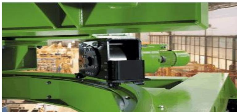
**Figura 2 – Recurso físico para movimentação - Bloco de rodas**
