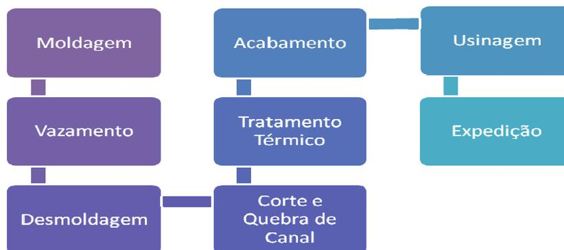
**Figura 1:** Fluxograma do processo de fabricação de peças fundidas
