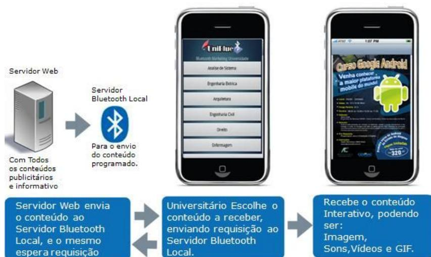
Figura 4: Ilustração do Funcionamento do Protótipo
