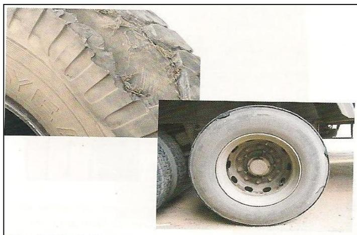
**Figura 6:** Indicador de não-conformidade tipo Deslocamento na região do ombro do pneu
