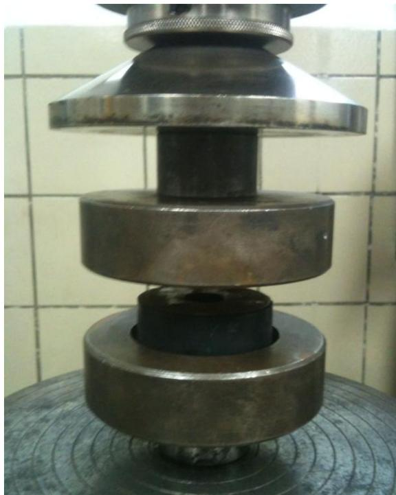
**Figura 7:** Configuração da máquina de teste de compressão.
