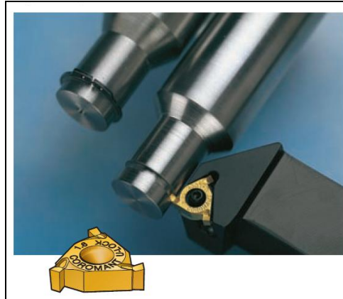
Figura 4: Microusinagem em pinos
