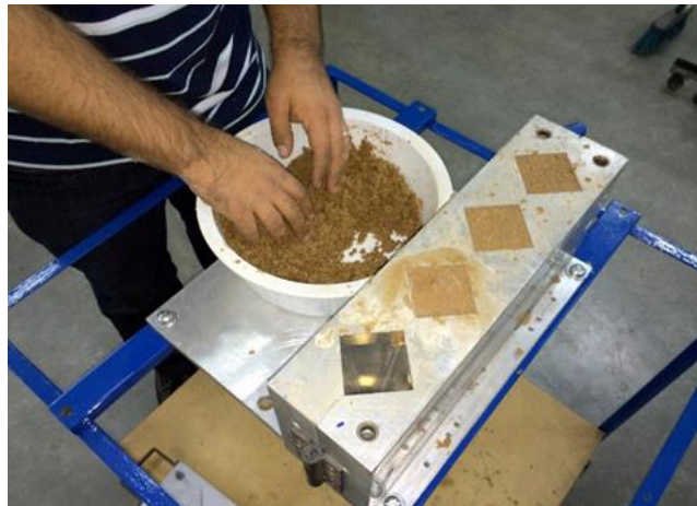
Figura 6: Colocação do material composto nas cavidades da matriz
