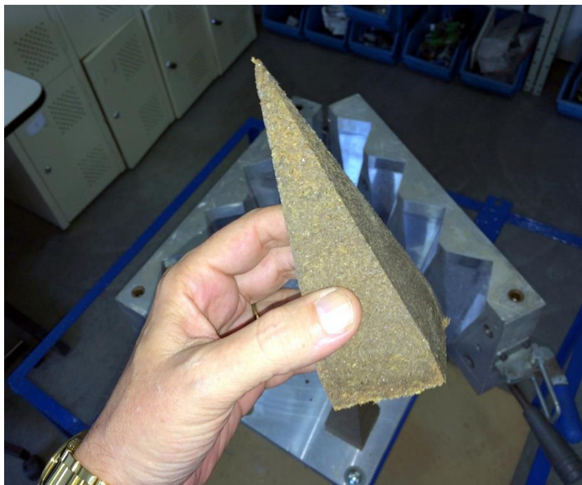
Figura 9: Protótipo do absorvedor piramidal obtido a partir de um compósito de cascas de arroz moídas e pó de resíduos de MDF ( Medium-Density Fiberboard )
