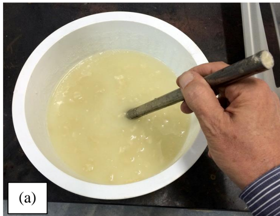
Figura 5: Preparação do amido diluído em água (a) e pesagem dos materiais (b)
