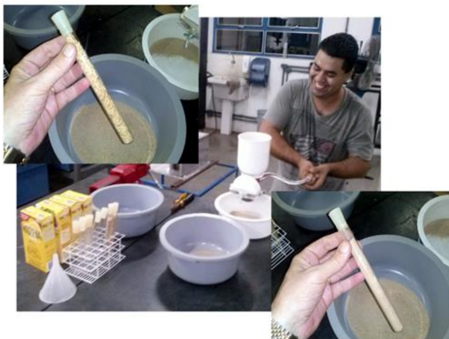
Figura 4: Processo de moagem da casca de arroz e as amostras obtidas
