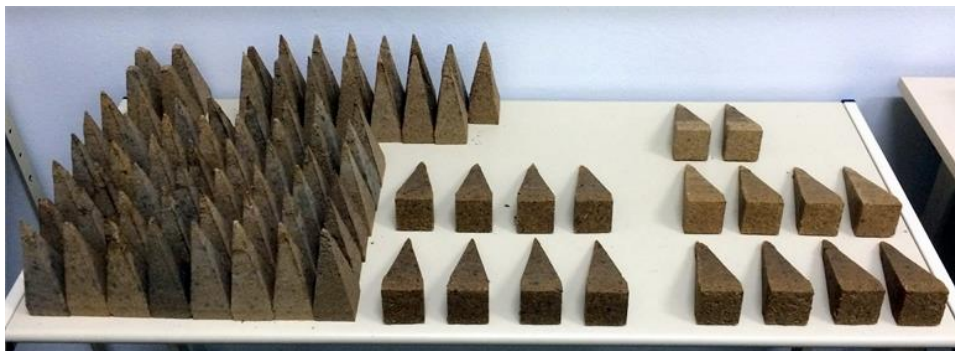
Figura 10: Absorvedores piramidais prontos para os testes experimentais
