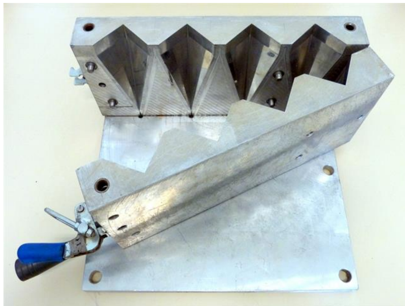
Figura 3: Vista superior do protótipo da matriz desenvolvida para obtenção dos absorvedores piramidais
