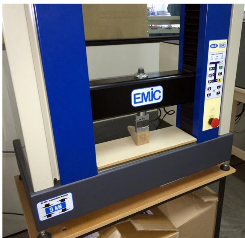
Figura 11: Amostra do absorvedor piramidal colocada na máquina para ensaio de compressão
