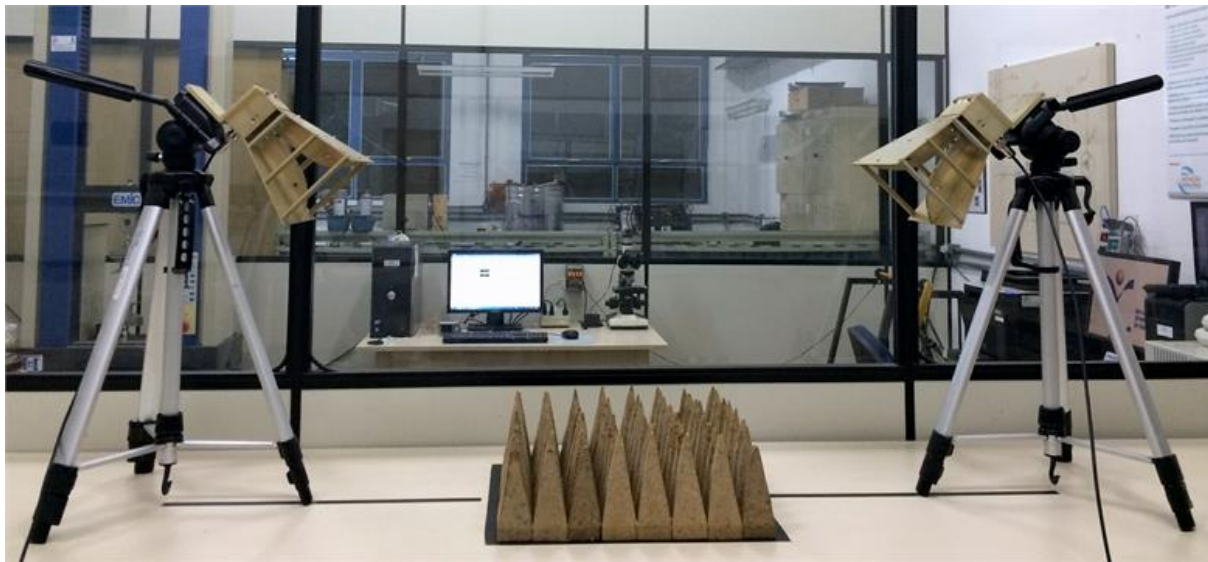
Figura 14: Aspecto da área de testes com o conjunto de absorvedores piramidais no centro
