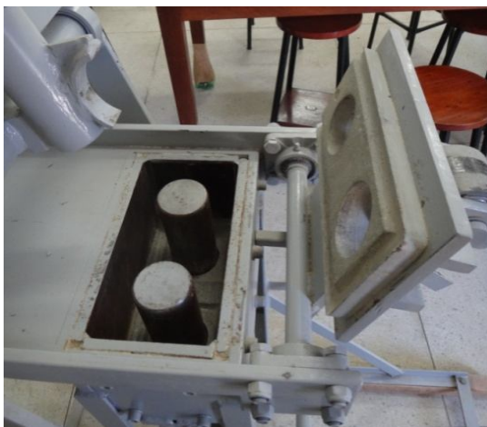
Figura 6: Molde utilizado para a confecção dos tijolos
