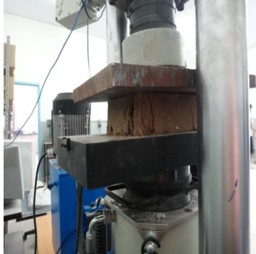
Figura 8 – O instante da ruptura do tijolo
