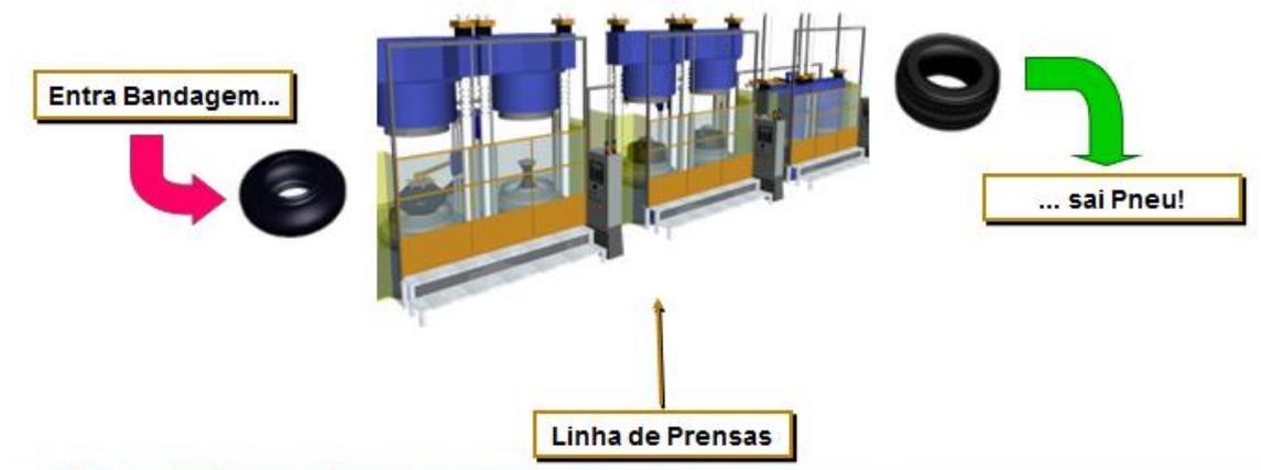
**Figura 2: Fluxo da transformação da bandagem em pneu.**
