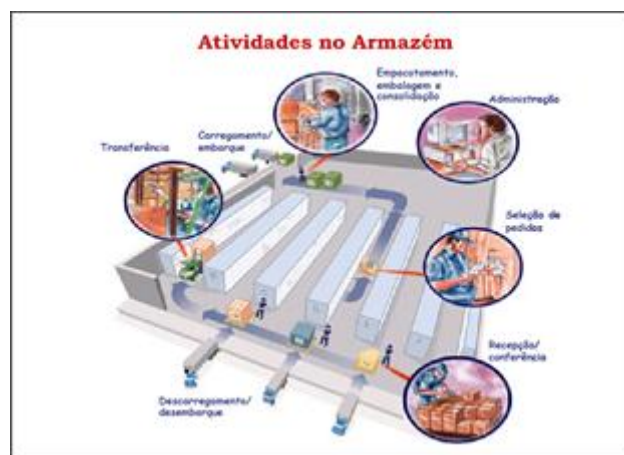
Figura 1: Atividades em um armazém. Fonte: UFRJ (2012)
