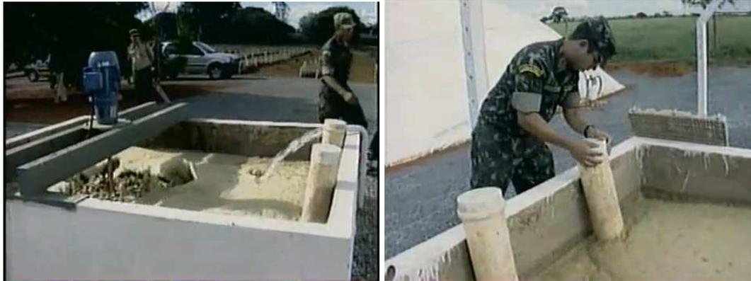
**Figura 3:** Misturador de estrume com água do 1º Regimento de Cavalaria de Guarda (RCG).
