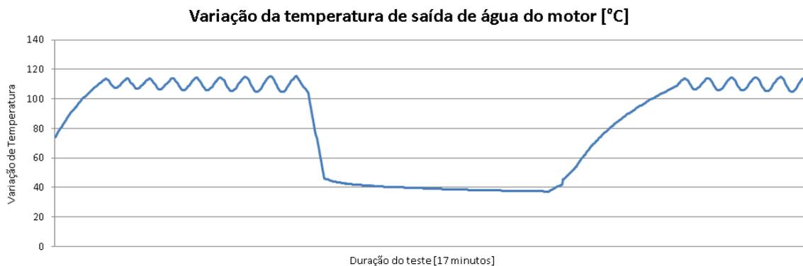
Gráfico 4 - Variación na temperatura na condição final de ensaio (fonte: Software AVL Puma Open)
