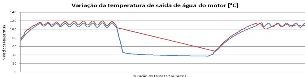
Gráfico 5 - Variación na temperatura na condição final de ensaio (fonte: Software AVL Puma Open)
