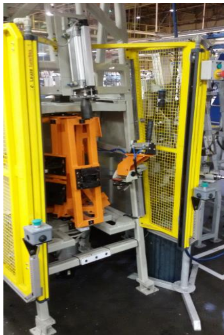
Figura 10: Máquina de cravamento da coluna de direção Atual
