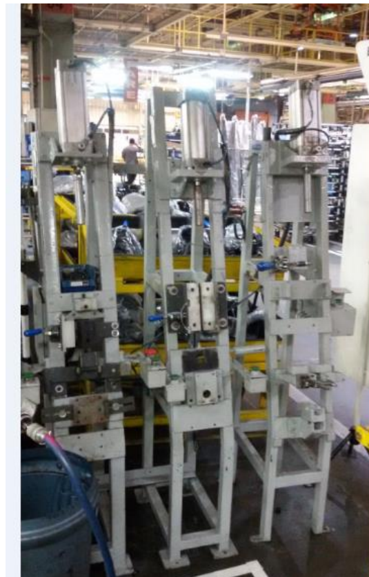
Figura 9: Máquina de cravamento da coluna de direção
