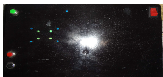
Figura 5- Vista externa do painel. LEDs azuis correspondem ao estado de travamento dos grampos manuais e os LEDs verdes correspondem à presença de componentes.
