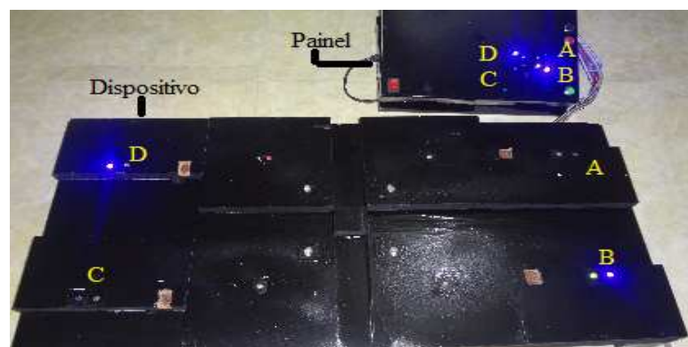
Figura3 - LEDs indicadores permitem o acompanhamento dos ciclos de operação e de manutenção do dispositivo diretamente pelo painel.
