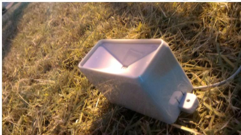
*Figura 3 - Pluviômetro Eletrônico – Fonte: Autor*
