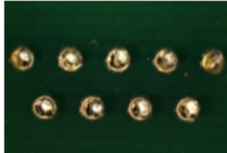
Figura 6: Falhas visuais no preenchimento pelo lado inferior.
