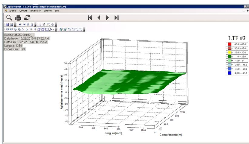
**Figura 2:** Imagem interpolada de uma Bobina-Fonte: Logger Viewer.
