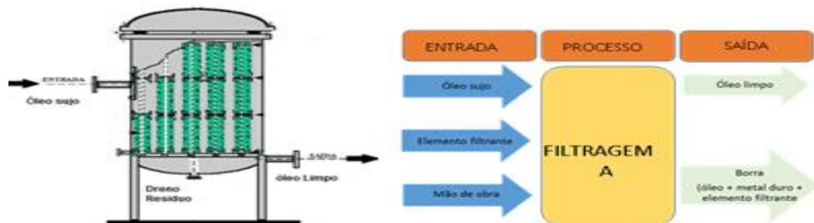
**Figura 7:** Região interna de filtro tipo aluvião. Fonte: Material interno da empresa.
