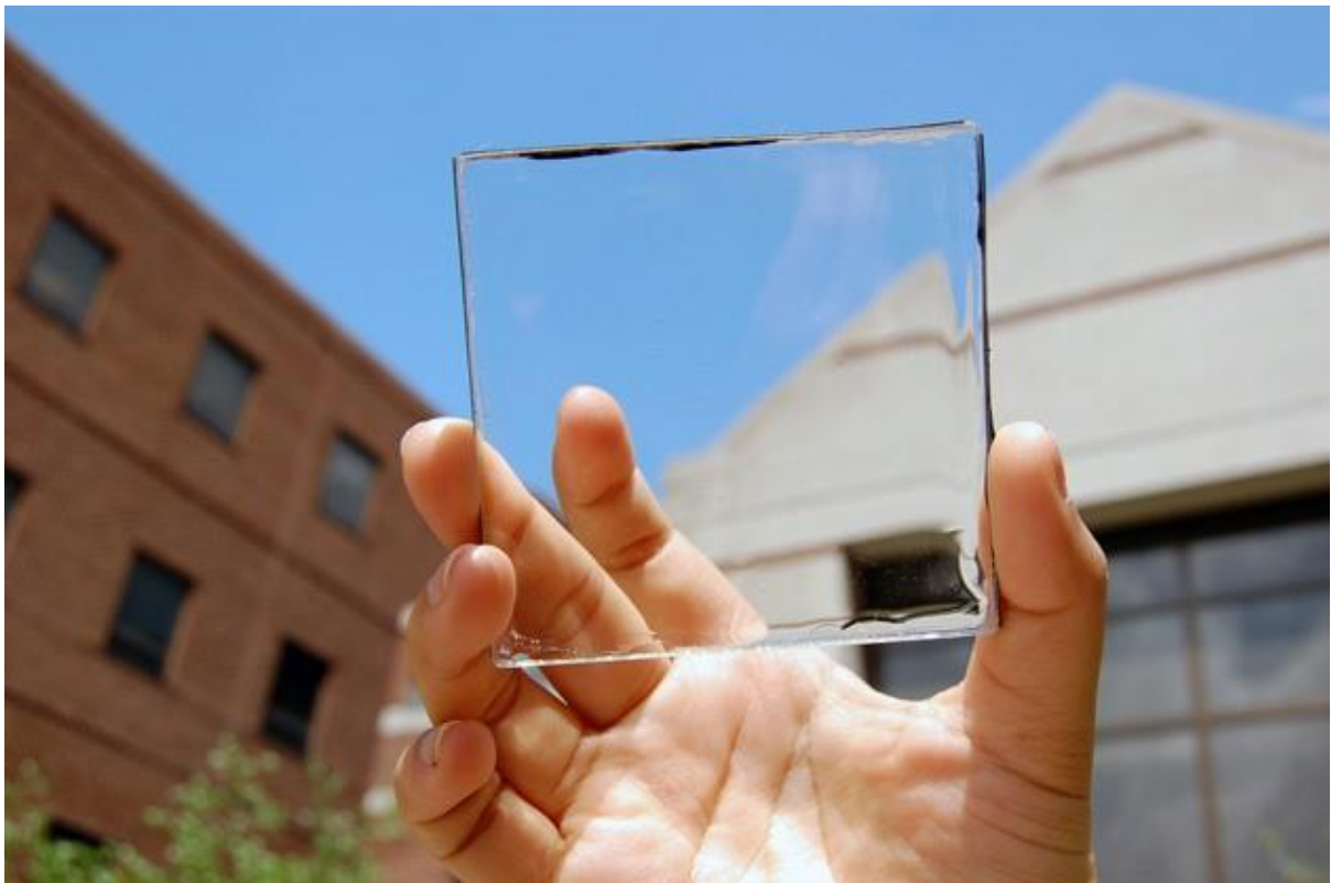
Figura 2: Lâmina adesiva transparente, que contém células fotovoltaicas.
