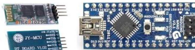
**Figura 8:** Módulo Bluetooth à esquerda, e à direita o Arduino Nano V3. Fonte: Dados da pesquisa
