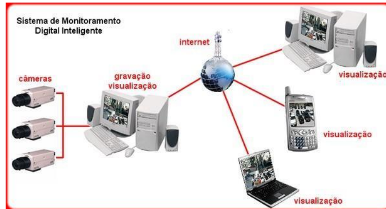
Figura 1: Estrutura básica de um sistema de monitoramento
