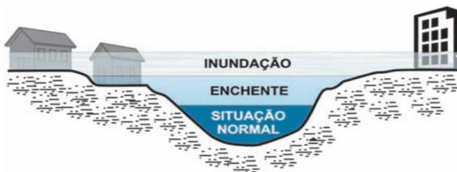
Figura 3: Perfil esquemático do processo de enchente e inundação Fonte: Ministério das Cidades/IPT (2007)
