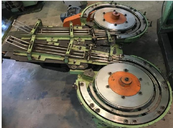
Figura 5: Equipamento de enrolar aba que será utilizado no novo projeto.
